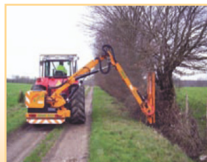
Opération de taille à l'aide d'outils réalisant une coupe nette. Photo : Chambre d'agriculture de Seine-Maritime
